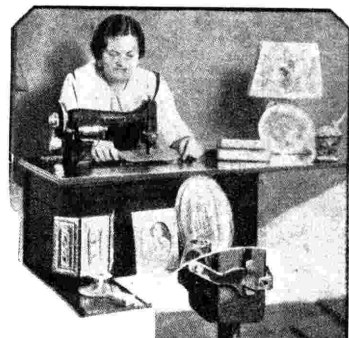
In alto il lavoro sui metalli con la macchina da cucire. Sotto, gli stampi che pigliano il posto dell'ago.
