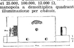
Uno *chassis* d'alluminio dalle seguenti dimensioni: altezza cm. 7, lunghezza cm. 35, larghezza centimetri 25, spessore mm. 4. Tre schermi per valvole in alluminio cilindrici. Tre schermi per bobine d'alta frequenza cilindrici.
