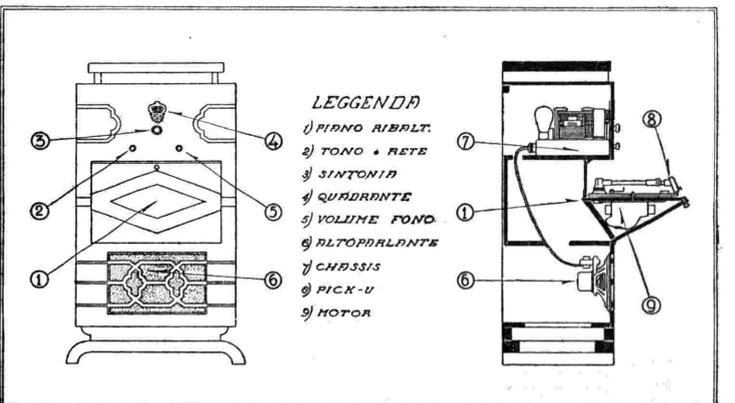
Fig. 2. - Un radiofonografo e i suoi componenti
