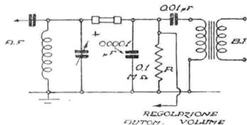
Fig. 1. — Inserzione di un rivelatore ad ossido di rame con possibile applicazione della regolazione automatica del volume.
