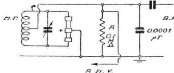
Fig. 3. — Rivelazione con raddrizzatore ad onda completa.
