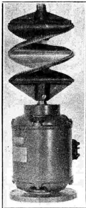
Ricevitore per televisione a spirale di specchi (Telode).
