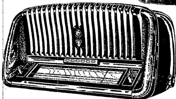
Supereterodina a 8 valvole con amplificazione di alta frequenza e grande potenza di uscita • 3 gemme in onde corte, 1 in onde medie, 1 in onde lunghe • 6 circuiti accordati • Potenza di uscita 10 Watt indistorti • 2 altoparlanti • Presa per fonoriproduttore • Ingresso bilanciato per l'impiego dell'antenna antiparassitaria "MAGNETI MARELLI", • Occhio magico • Valvole originali "FIVRE", • Alimentazione in C. A. per tensioni comprese fra i 100 e 200 V e 42 ÷ 100 periodi
