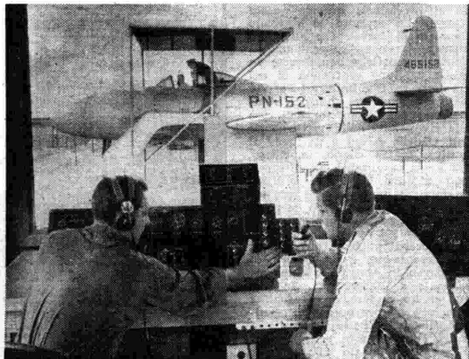
Avieri istruttori che controllano il funzionamento pratico di un apparecchio a reazione. L'aereo, che si vede, è uno «Shooting Star» solitamente fissato al suolo da incastellature in cemento.
