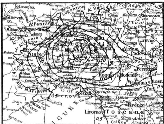
Fig. 6 - Zona di servizio diurna prevista per la stazione di Milano I - 150 kW - 899 kc/s - 333,7 metri (situazione futura).
