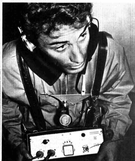
verso la vetta. Pipa in bocca, Jean Pellissier apre la strada, seguito dal radiocronista Marsico e dal portatore Silvano Meynet. — Prove di collegamento dalla cresta di Furggen con microfono rivestito di materia plastica applicato al petto. La cuffia monoauricolare consentiva al radiocronista di ascoltare il posto di Fürggen e i suggerimenti di Pellissier
