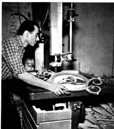
Nello scantinato di viale Mazzini i falegnami lavorano tutto il giorno a preparare sui disegni i pezzi necessari per i vari ambienti. Uno di essi è qui alle prese con l'insegna di una locanda
