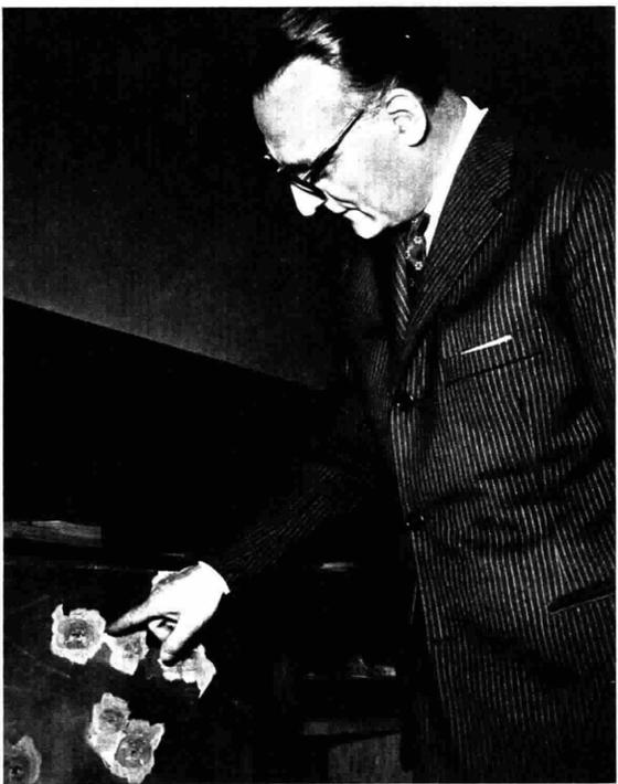
Corazza di materia plastica. È stato recentemente sperimentato a Torino questo nuovo tipo di corazza in resine di cresilformaldeide. Il blocco, dello spessore di 40 mm., ha resistito, a distanze comprese fra i 50 e i 300 metri, a tiri di un cannone di 20 mm. L'ing. Manlio Muzzoli, direttore dello stabilimento RV Materie plastiche, indica i fori d'entrata dei proiettili. Ha annunciato che un nuovo tipo di corazza, sottilissimo, offrirà una resistenza tripla
