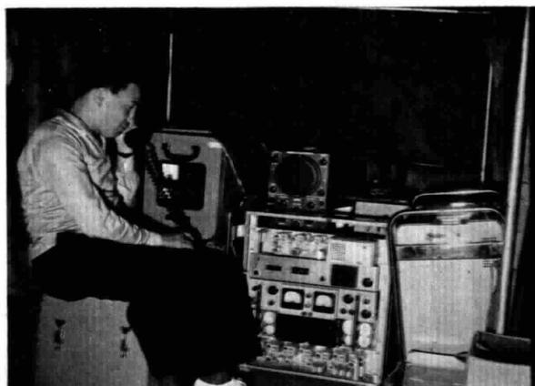
Un tecnico in collegamento telefonico con la postazione più vicina della serie di ponti radio che convogliano i segnali audio e video alla stazione trasmittente
