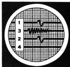
Irregolarità delle pressioni di scoppio nel cilindro 3 dovuta a pre-ignizione, e nel cilindro 4 dovuta a mancata accensione per perdita di corrente alla candela.
