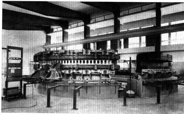
Elementi del sincrotrone in fase di montaggio
