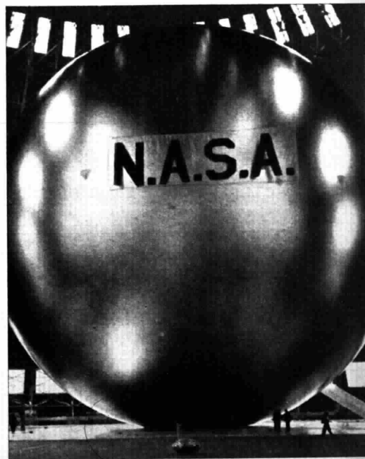
Il satellite Echo, un gigantesco pallone di plastica, coperto di una lamina di alluminio. E' stato il primo satellite lanciato dagli americani nel quadro degli esperimenti per le comunicazioni intercontinentali via spaziale
