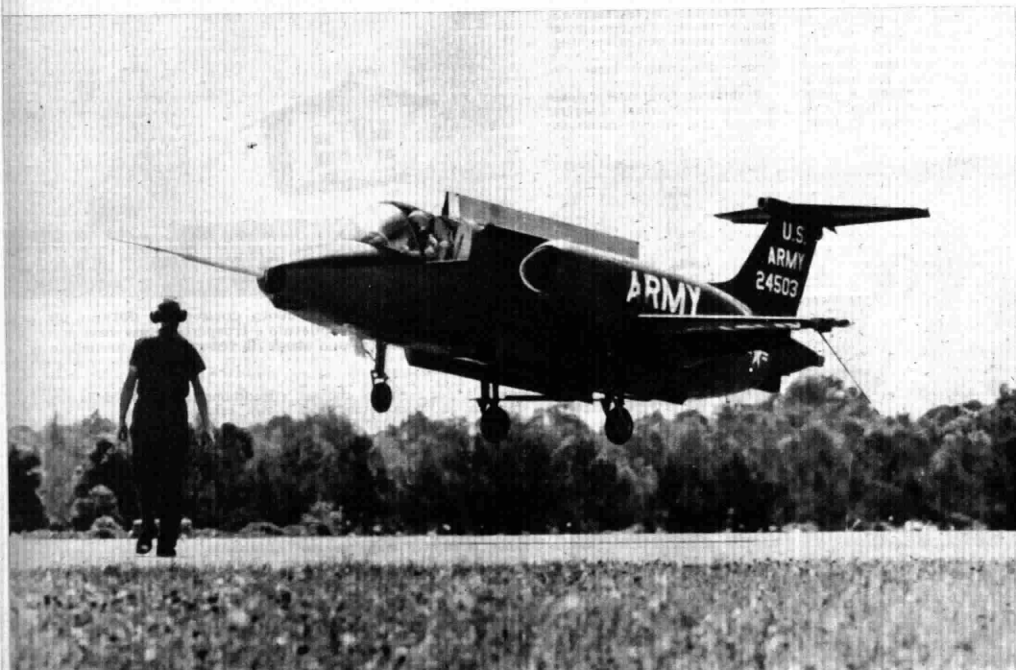
Il bireattore americano « XV-4A Hummingbird » che, capace di velocità superiori agli 800 chilometri orari, può decollare verticalmente. L'apparecchio, creato dalla « Lockheed », sarà adottato prossimamente dalle forze armate degli Stati Uniti
