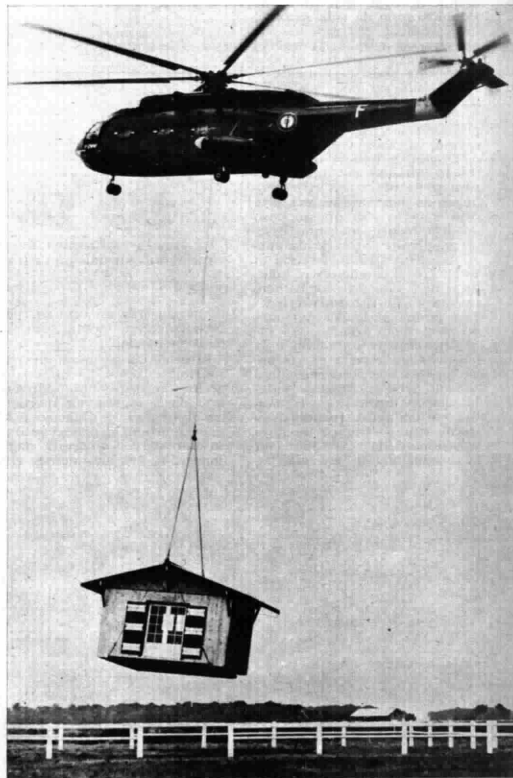
Un elicottero francese di nuova costruzione, durante un volo dimostrativo, ha sollevato e trasportato una casa prefabbricata. Il mezzo può alzare da terra più di 4 tonnellate
