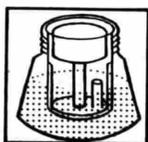
La fiamma porta all'ebollizione e quindi a temperatura alla soltanto l'acqua della caldaia. Prima di toccare il caffè, l'acqua bollente si mescola con quella tiepida contenuta nel "Termocrem".
