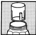
L'acqua per il vostro caffè, viene versata sia nella caldaia della caffettiera che nel serbatoio speciale del "Termocrem", sino al livello segnato. Questo serbatoio ha le pareti doppie a camera d'aria, e mantiene l'acqua in esso contenuta a temperatura molto bassa.
