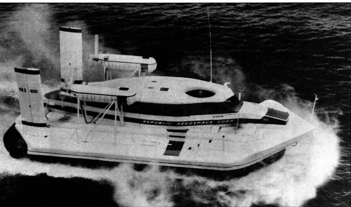
Un tipo recentissimo di «Hovercraft» costruito in America su licenza dell'inventore inglese Christopher Cockerell. Può trasportare ventiquattro passeggeri alla velocità di 120 chilometri all'ora e attualmente è in servizio di linea nella zona di Long Island
