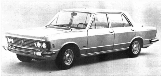
Ecco l'ultima nata della Fiat: la « 130 ». E' una vettura di prestigio, a cinque posti, con motore a 6 cilindri di 2860 cmc. La velocità è di circa 180 chilometri orari
