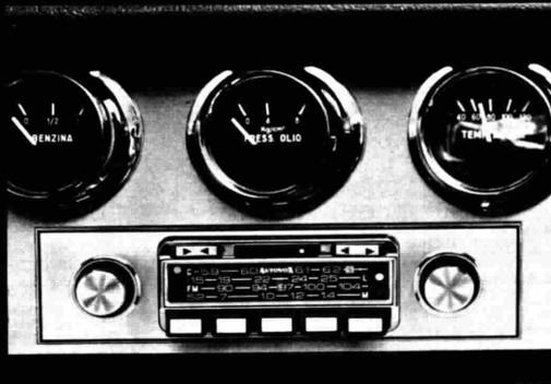
TIFFANY (RA 191). Autoradio superdotata. Due ricerche automatiche delle stazioni: a tasti ed elettronica. Quattro gamme d'onda OL - OM - OC e modulazione di frequenza. Prese per giradischi e giranastri Autovox.
