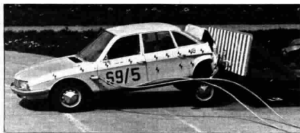
Una NSU RO 80 durante una prova di urto posteriore
