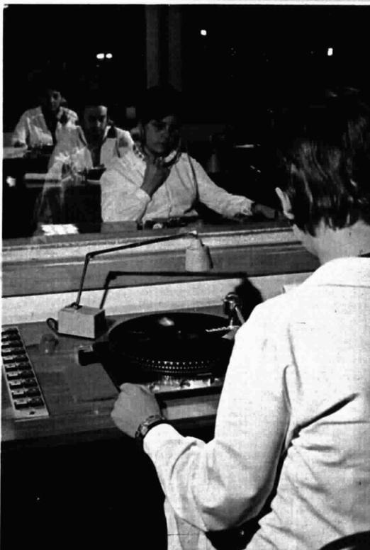
passa (foto grande in alto) alla matrice del disco, quella che nel gergo dei discografici si chiama « transfer ». Poi, con il bagno galvanico (qui sopra, a sinistra), dalla matrice si preleva il disco. Il disco finito nelle presse (a destra) darà vita ai dischi. Da una sola pressa escono 195 copie l'ora
