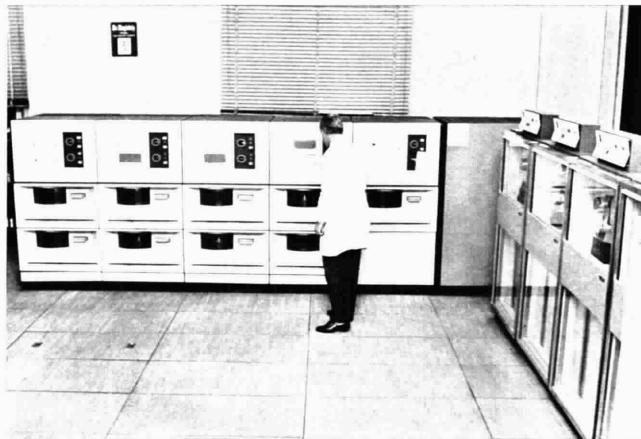
A sinistra, il vicequestore Ilio Corti, direttore del Centro elettronico della polizia, nella sala del calcolatore IBM 360/40 che dispone di un «cervello» con 128 mila posizioni di memoria. Sullo sfondo si vedono le unità con i nastri magnetici dove vengono immagazzinate le informazioni. L'elaboratore è in grado di compulsare e aggiornare questo moderno schedario con estrema rapidità ed esattezza. Qui sotto, un archivio a dischi capace di 500 milioni di informazioni e i pannelli elettronici dell'unità di controllo i cui terminali si trovano nelle principali questure d'Italia
