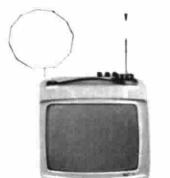
Televisione M 12 portatile da 12 pollici - transistorizzato - sintonia a diodi a varicap con preselettori a pulsanti - alimentazione a corrente o a batteria - colori bianco, rosso, arancio. L. 99.000
