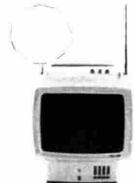
Televisore T 12 portatile universale da 12" - completamente transistorizzato - sintonia elettronica - alimentazione a rete (120, 160, 220 V.) o a batteria esterna o a batterie incorporate (12 V.) - caricabatterie incorporato - altoparlante frontale - colori bianco o rosso. L. 130.000
