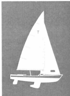
TEMPEST - equipaggio 2 uomini; lunghezza: 6,70 m.; larghezza: 1,97 m.; tirante: 1,14 m.; vela: 23 m 2 ; spinnaker; chiglia fissa; plastica; 2 milioni (senza vele). In serie olimpica dal 1972. Progettata nel 1964 da Jan Proctor. Distintivo: lettera T
