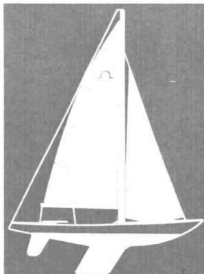
SOLING - equipaggio 3 uomini; lunghezza: 8,15 m.; larghezza: 1,90 m.; tirante: 1,30 m.; superficie di vela: 21,70 m 2 ; spinnaker; chiglia fissa; prezzo: 3-4 milioni. In serie olimpica dal 1972. Progettata nel 1967 dal norvegese Jan Linge. Distintivo: lettera omega
