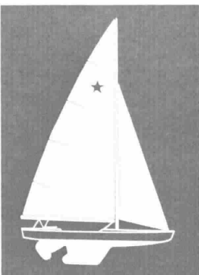
STAR - equipaggio 2 uomini; lunghezza: 6,92 m.; larghezza: 1,73 m.; tirante: 1,01 m.; vela: 26 m 2 ; chiglia a pinna; legno o plastica; 2 milioni (senza vele). In serie olimpica dal 1932. Progettata nel 1911 da William Gardner (USA). Distintivo: stella
