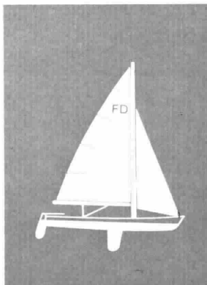
FLYING DUTCHMAN - equipaggio 2 uomini; lunghezza: 6,05 m.; larghezza: 1,70 m.; tirante: 1,10 m.; vela: 16 m 2 ; spinnaker; legno o plastica; prezzo: 1,2-1,3 milioni. In serie olimpica dal '60. Progettata nel '51 dall'olandese U. van Essen. Segno distintivo: lettere F.D.
