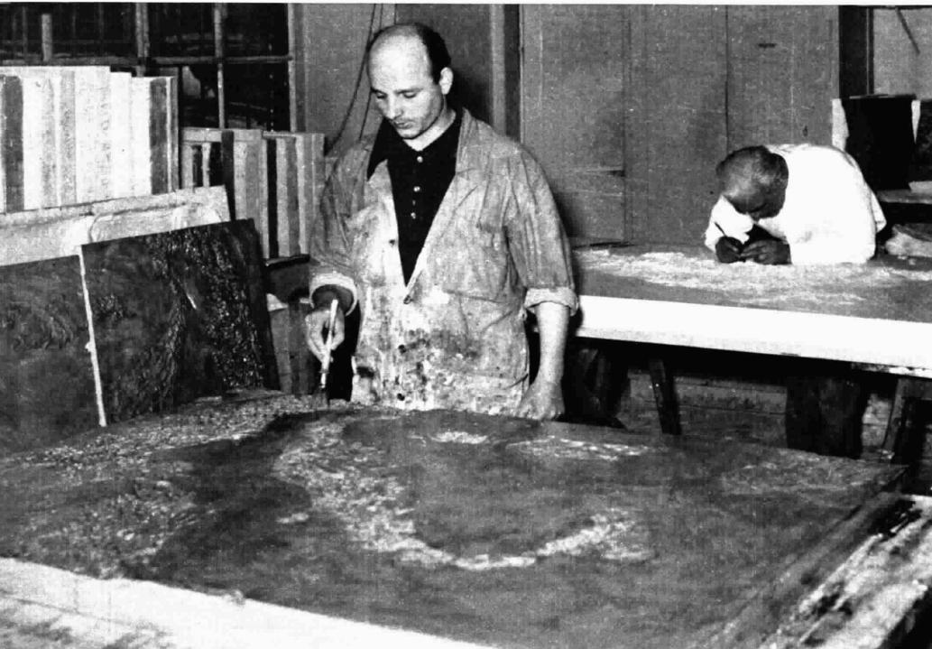
Nella sede fiorentina dell'Istituto, sezione plastici: così viene preparato il modello in gesso per le macchine termoplastiche
