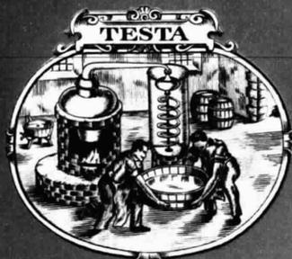
Nel primi minuti del processo di distillazione della grappa esce la "testa" ricca di alcool metilico. Viene sempre scartata.
