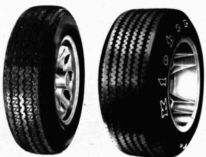
Pneumatici radiali Kléber per competizioni appositamente realizzati per i rallies italiani che si contraddistinguono per l'alternarsi di fondi accidentati a strade asfaltate.
