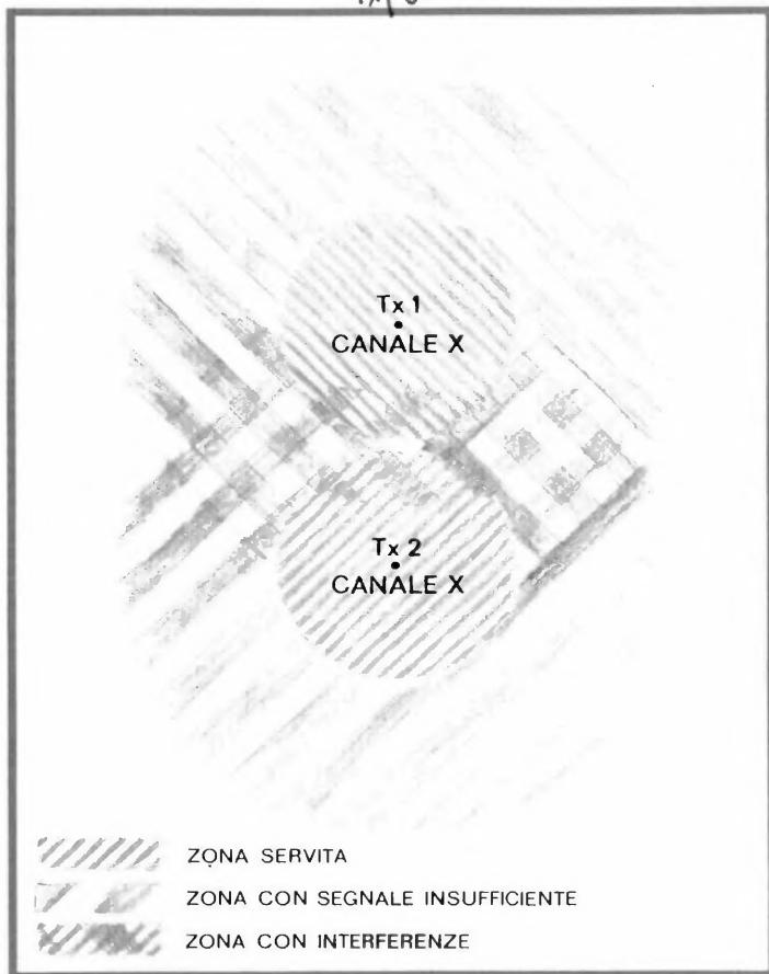
DUE TRASMETTITORI ISOCANALI AVENTI AREE DI SERVIZIO VICINE PROVOCANO MUTUE INTERFERENZE (FIGURA 5)
