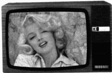
o in SECAM. E' dotato di circuito di preaccensione. Riceve con la massima fedeltà, grazie al cinescopio da 110° a "collo stretto".
