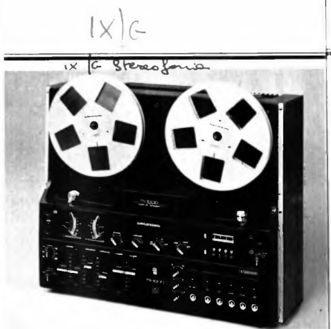
GRUNDIG TS 1000 — E' un registratore ad alta fedeltà a 3 motori a 2 o 4 piste. Ha tre velocità: 4,75-9,5-19 cm al secondo. Ha la possibilità di essere comandato a distanza, via cavo
