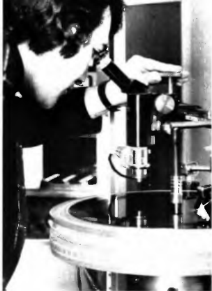
Milano. Il « transterista » Francesco Brambilla controlla al microscopio i solchi dell'acetato matrice appena inciso. A sinistra in alto, il tecnico del suono Plinio Chiesa mentre procede all'eliminazione di un segmento di nastro rovinato. Qui a fianco, particolare della console della macchina di trascrizione
