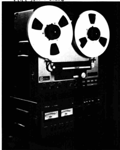
Il Teac A7300 RX, un registratore a bobine ad altissimo livello. L'unità inferiore ha funzione di controllo e di mixer a quattro ingressi
