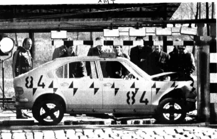
Da sinistra a destra: un esperimento dei tecnici Alfa per lo studio analitico della dinamica dell'urto; prova di fatica su porte e serrature
