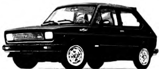
127 "1050" tre porte. Versione Sport Motore da 70 CV, 160 km/h, schienali anteriori con poggiatesta incorporato, sedile posteriore sdoppiato con schienali ribaltabili, strumentazione e styling decisamente sportivi.
