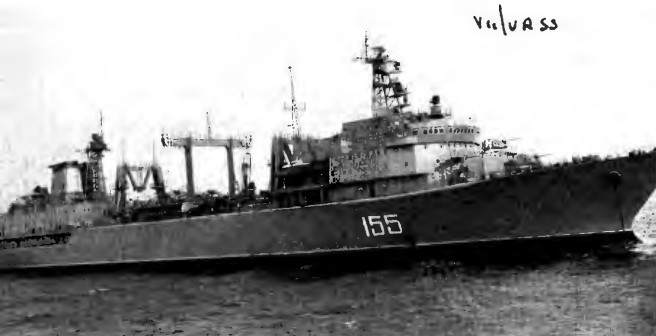
«BEREZINA» , rifornitrice di squadra, 35.000 tonnellate: è la più recente unità ausiliaria sovietica. L'armamento è composto da 1 lanciatore per missili superficie-aria del tipo SA.N.4; 2 cannoni da 57 mm; 4 mitragliere da 23 mm; due lanciarazzi del tipo RBV
