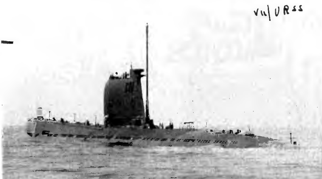
II. SOMMERGIBILE «FOXTROT». A propulsione convenzionale, ha un dislocamento in superficie di 1960 tonnellate e in immersione di 2400. La lunghezza è di 91,5 metri, la larghezza di 7,5, la velocità di 18 nodi, pari a circa 35 chilometri all'ora
