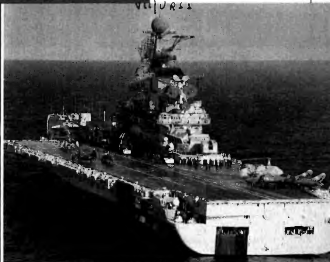
LA PORTAEREI « KIEV », 37.000 t. Armamento: 4 lanciatori doppi del tipo SS.NX.12; 2 lanciatori SA.N.3; 2 lanciatori binati per missili SA.N.4; 1 lanciatore per missile antisommergibile; 4 cannoni da 76 mm; 2 lanciasiluri; 8 mitragliere da 23 mm; 2 lanciarazzi antisommergibili
