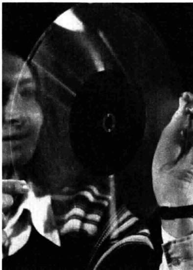
Ecco il «quarto» videodisco: leggero, trasparente, pieghevole, a lettura ottica, cioè senza la puntina, ad altissima fedeltà
