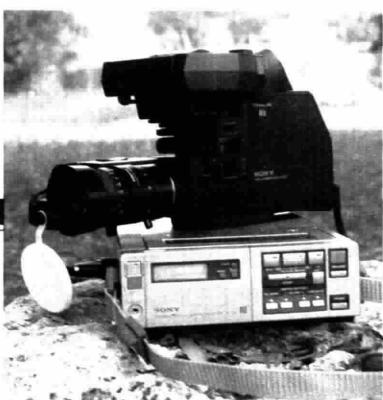
strazione. Nonostante le ridotte dimensioni (pesa 4,5 kg e misura 215 mm di larghezza, 80 mm di altezza e 325 mm di profondità) esso fornisce immagini a colori di elevata qualità e consente di realizzare effetti speciali come ricerca oscillante dell'immagine, movimenti rallentati, fermo e ricerca immagine, velocità doppia, tipici dei VCR professionali. Collegato alla telecamera portatile HVC-3000 consente di rivedere automaticamen-
