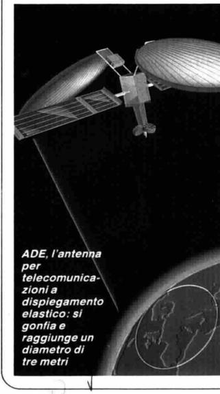
**ADE, l'antenna per telecomunicazioni a dispiegamento elastico: si gonfia e raggiunge un diametro di tre metri**
